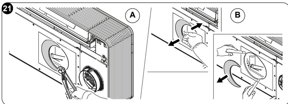
Det bakre skyddet är även förinställt för den rektangulära inloppskanalen. Om ni föredrar denna typ av installation ska den rektangulära förformen brytas av och ett luftintagsgaller av lämplig storlek för inloppskanalen användas.
