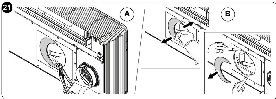
La copertura posteriore è predisposta anche per il canale di aspirazione rettangolare. Nel caso si preferisca questa tipologia di installazione, rompere la pretranciatura rettangolare e utilizzare una griglia di aspirazione di dimensioni idonee al canale di aspirazione.
