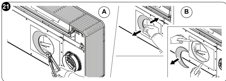
Το πίσω κάλυμμα είναι επίσης έτοιμο για το ορθογώνιο κανάλι αναρρόφησης. Εάν προτιμάτε αυτόν τον τύπο εγκατάστασης, σπάστε το προσημειωμένο ορθογώνιο και χρησιμοποιήστε μια γρίλια αναρρόφησης κατάλληλου μεγέθους για τον αγωγό αναρρόφησης.
