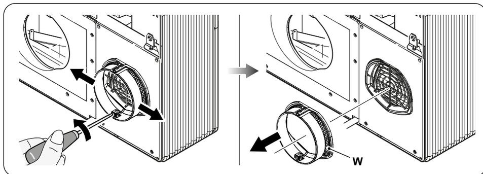
Bei Verwendung von Bohrungen mit  $\varnothing$  202 mm ist wie folgt vorzugehen:
