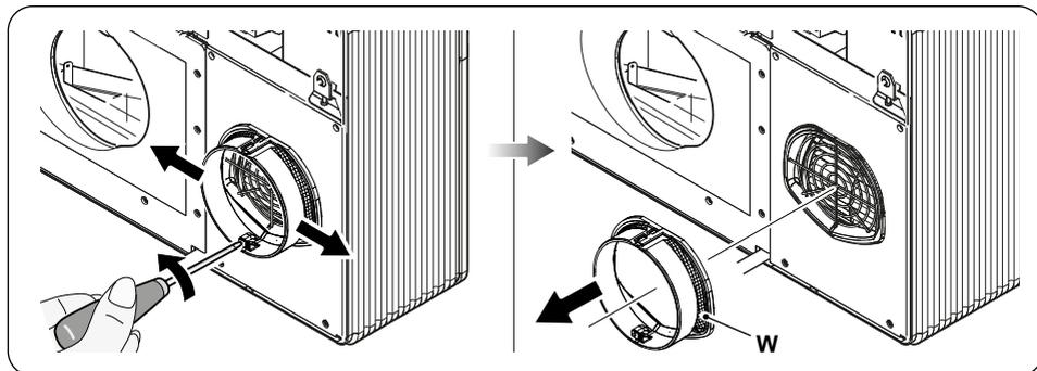
În cazul utilizării orificiilor cu  $\varnothing$  202 mm procedați după cum urmează:
