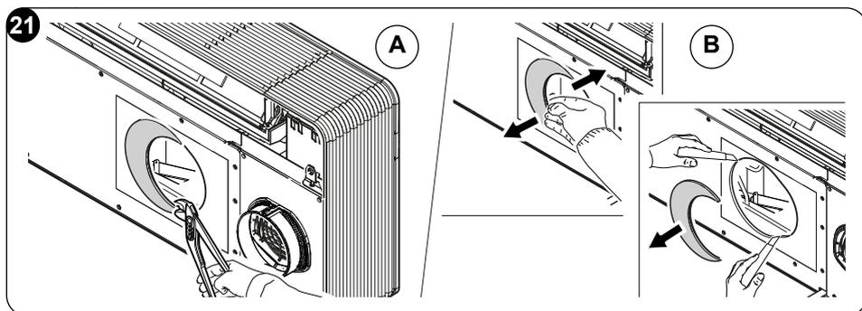
Le couvercle arrière est également prévu pour le canal d'aspiration rectangulaire. Si l'on préfère ce type d'installation, il faut casser la partie rectangulaire prédécoupée et utiliser une grille d'aspiration de taille appropriée pour le conduit d'aspiration.
