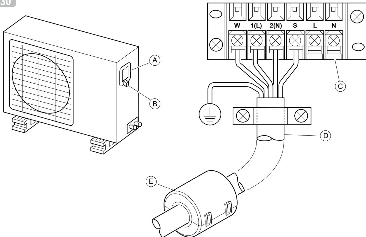
**Conexión del cable a la unidad exterior (fig. 30)**
